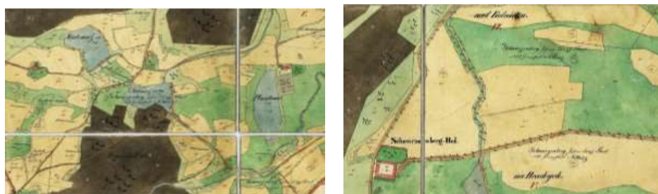
obr. 6 – Vlevo na výřezu indikační skici stabilního katastru vedení stoky Krčínka z rokle pod Hrádečkem k rybníku Dolní Nadýmač a dále pod lesem Doubrava. Část tohoto úseku je dodnes funkční a napájí sádky u Blažkovského rybníka. Vpravo je patrné stromy lemované vedení stoky Krčínka od Čichtického rybníka přes pole k lesu pod vrchem Libovka. (Mapový podklad ČÚZK).
