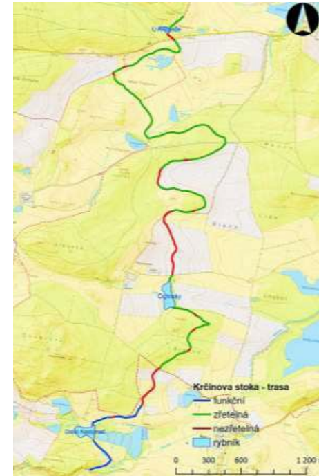
obr. 11 – Vlevo schéma vedení stoky Krčínka krajinou od lesní rokle pod Hrádečkem (dole) k bývalé lesovně U Ambrože (nahoře), s vyznačením původní hranice obory, podle map stabilního katastru a leteckého měřického snímkování. Vpravo schéma s vyznačením současného stavu stoky podle průzkumů in situ, doplněného o výsledky lidarového snímkování. (Mapový podklad ČÚZK).
